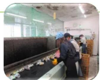
②ベルトコンベアで流され、廃乾電池類、再使用びん、ペットボトル等を手作業で取り除く。
